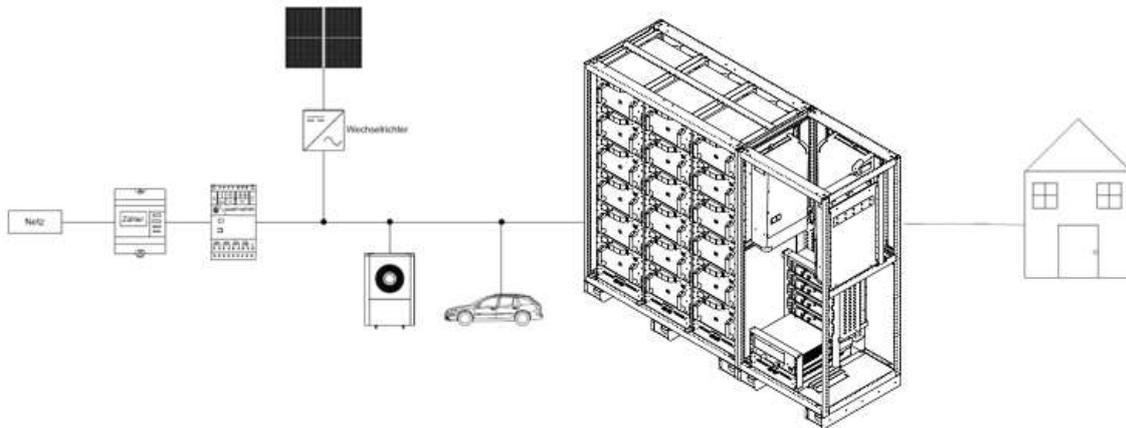
Die PV-Anlage hat eine Leistung >45kWp. Mit dem Smart-Meter am Netzübergabepunkt wird erfasst, ob Leistung bezogen oder eingespeist wird. Sind alle Verbraucher mit der PV-Leistung versorgt und es ist überschüssige Energie vorhanden, dann wird die Batterie geladen. Wird Energie aus dem Netz benötigt, unterstützt der Gewerbespeicher mit Batterieleistung.
