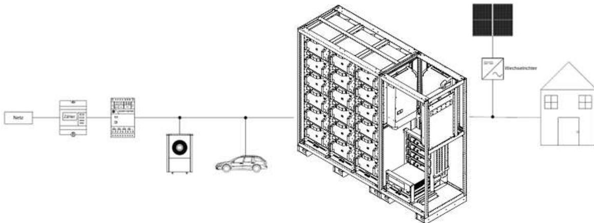
Die PV-Anlage hat eine Leistung <45kWp. Mit dem Smart-Meter am Netzübergabepunkt wird erfasst, ob Leistung bezogen oder eingespeist wird. Sind alle Verbraucher mit der PV-Leistung versorgt und es ist überschüssige Energie vorhanden, dann wird die Batterie geladen. Wird Energie aus dem Netz benötigt, unterstützt der Gewerbespeicher mit Batterieleistung.
