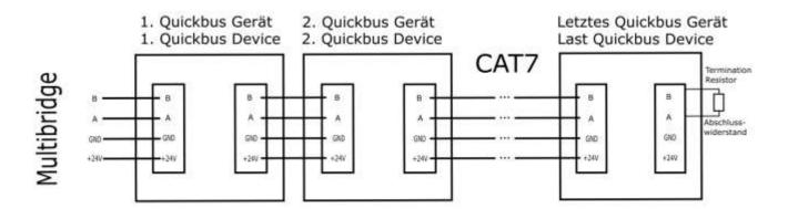
Auf dem COMEXIO Digital Input Modul ist der Abschlusswiderstand bereits integriert. Diesen können Sie dazuschalten, wenn der Schiebeschalter nach rechts geschoben wird.
